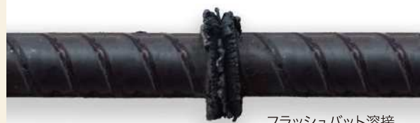
フラッシュバット溶接
