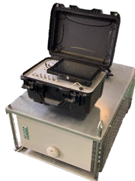
制御盤・制御用タブレット
