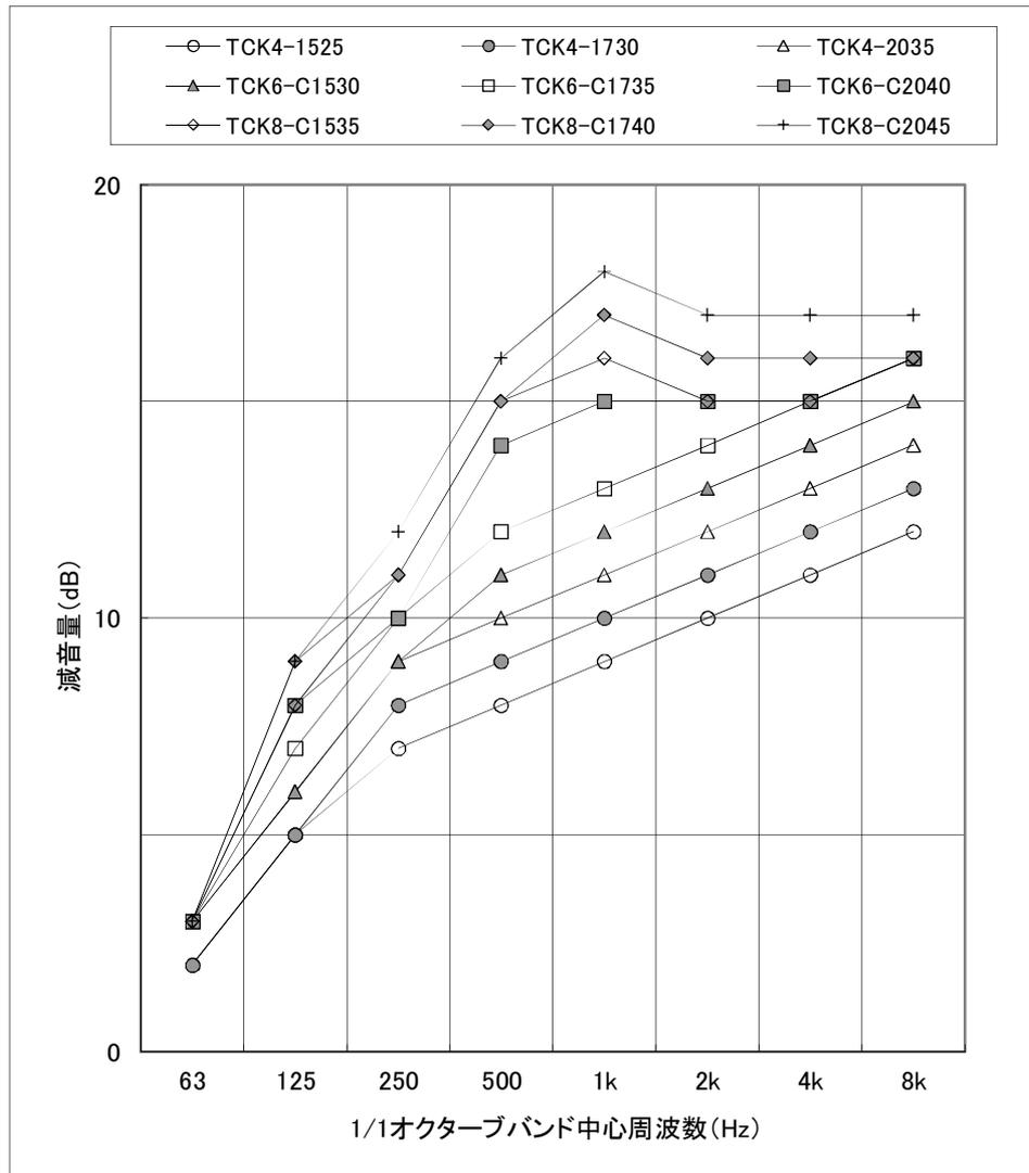
図 タートルチャンバー減音量評価値
