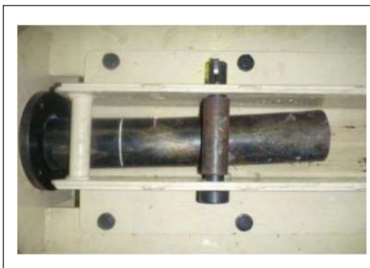
① 鋼管を台座にセット
