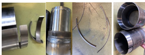
図-4 引張試験時の破壊形状
