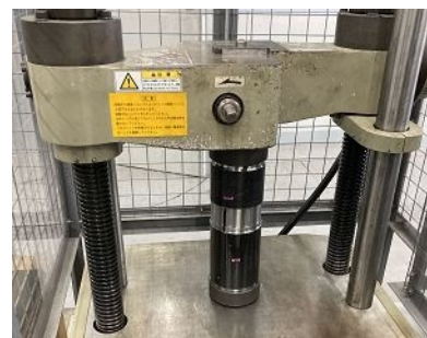
図-2 押込み試験状況
