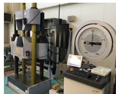
図-3 引張試験状況
