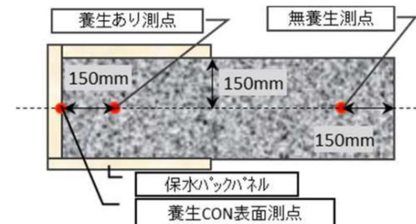
●養生をしたコンクリート表面と養生面内部の温度は同程度を示しており外気温の影響を受けていません。対して無養生時の温度は、外気温に影響され寒暖差による温度のばらつきが発生しています。
