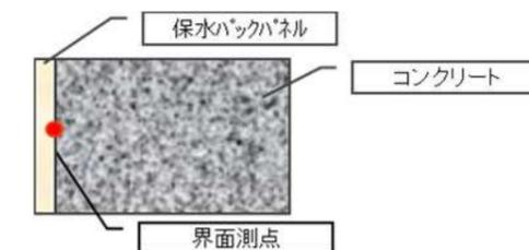
●水分蒸発を抑制することで保水状態を維持できます。
