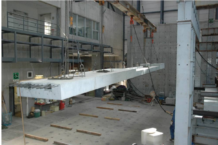
写真1 フルプレキャストスラブ全景
