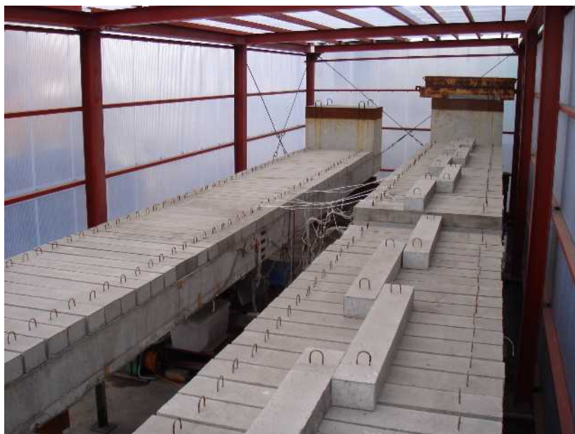
写真 7 12 m スパンの平板スラブ及び段差付きスラブの長期計測実験
