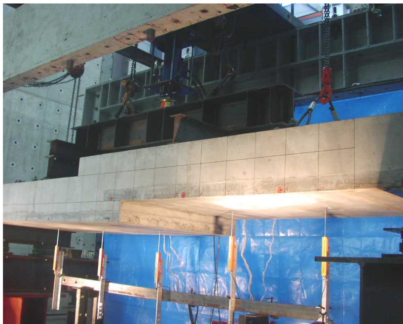
写真 5 段差スラブ付きスラブ試験体曲げ実験
