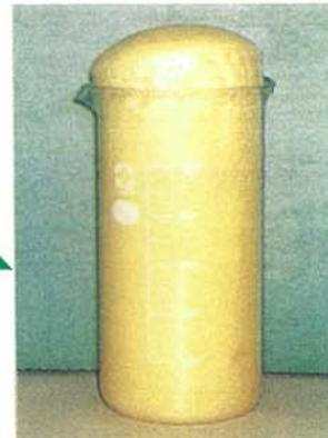
60秒後泡化完了 (ライズタイム)
